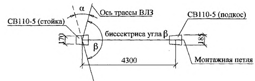
Схема установки стойки и подкоса
