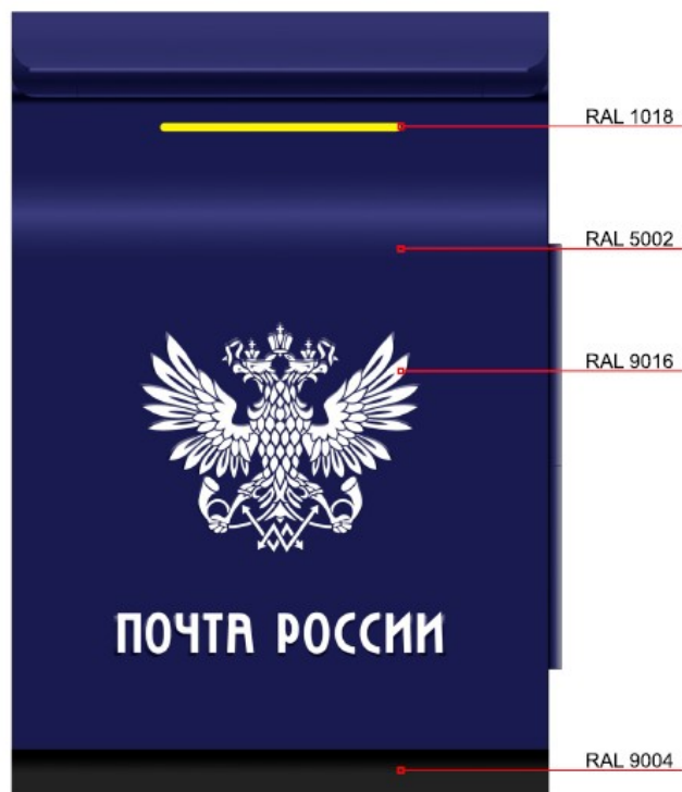
Рисунок Ж. Эскиз ящика почтового типа «Р»
