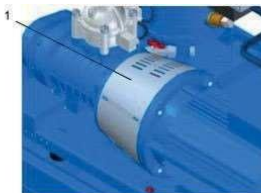
Рис. 5: Винтовой компрессор с прямым приводом
