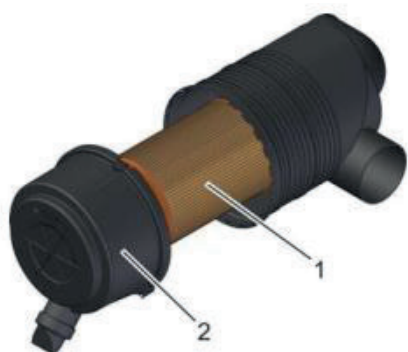
Рис. 36: Удаление крышки всасывающего фильтра
