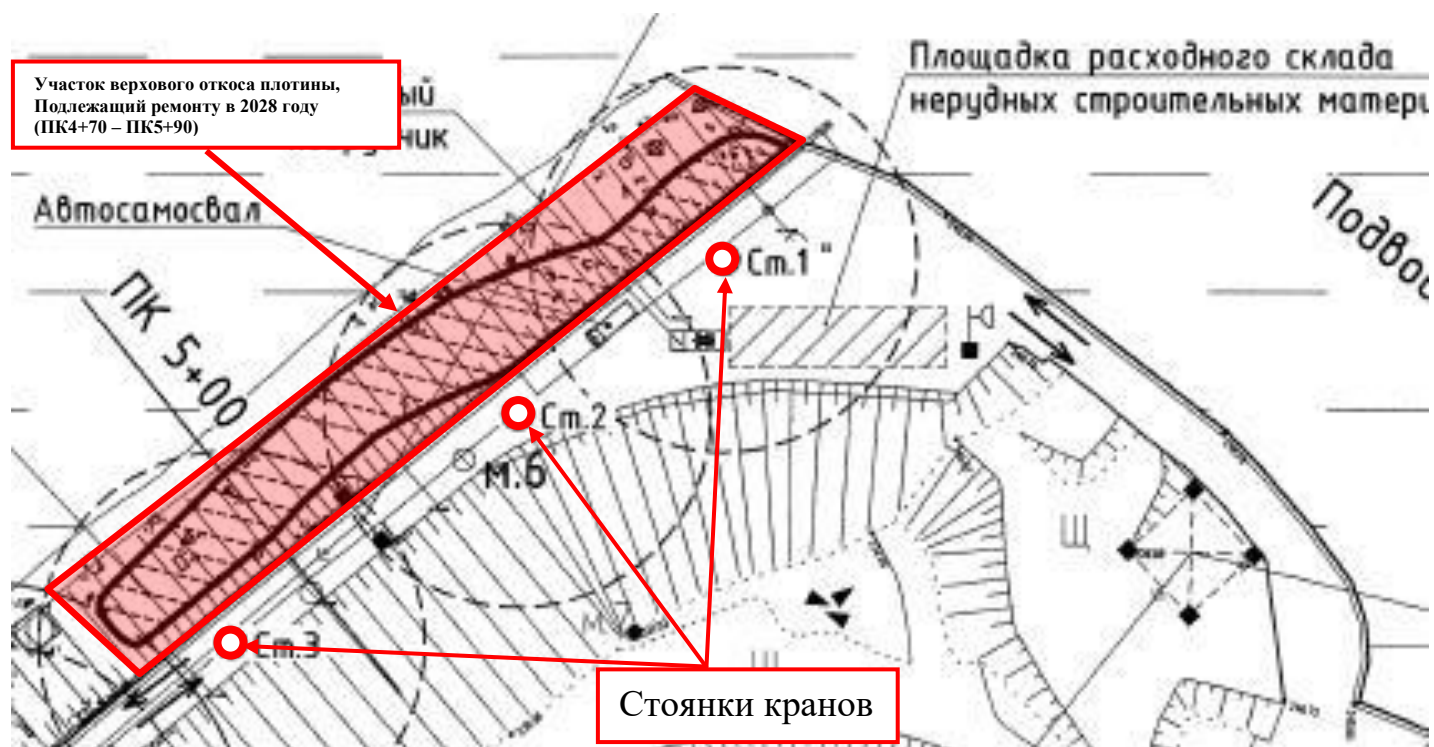
Рис.2. Схема расположения стоянок автокрана на ремонтируемом в 2028 году участке.
