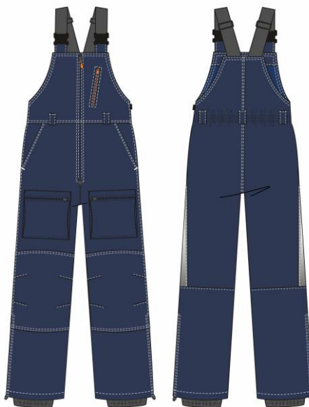
Рис. 8 Костюм мужской от общих производственных загрязнений утепленный для защиты от ОПЗ для рабочих/ИТР полукомбинезон
