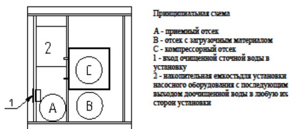
«ЦИКЛОН» с принудительным отведением доочищенной воды
