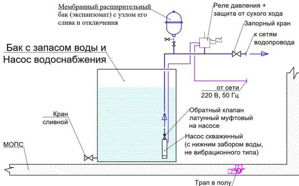
Рисунок 12 Принципиальная схема организации системы водоснабжения из накопительной емкости
