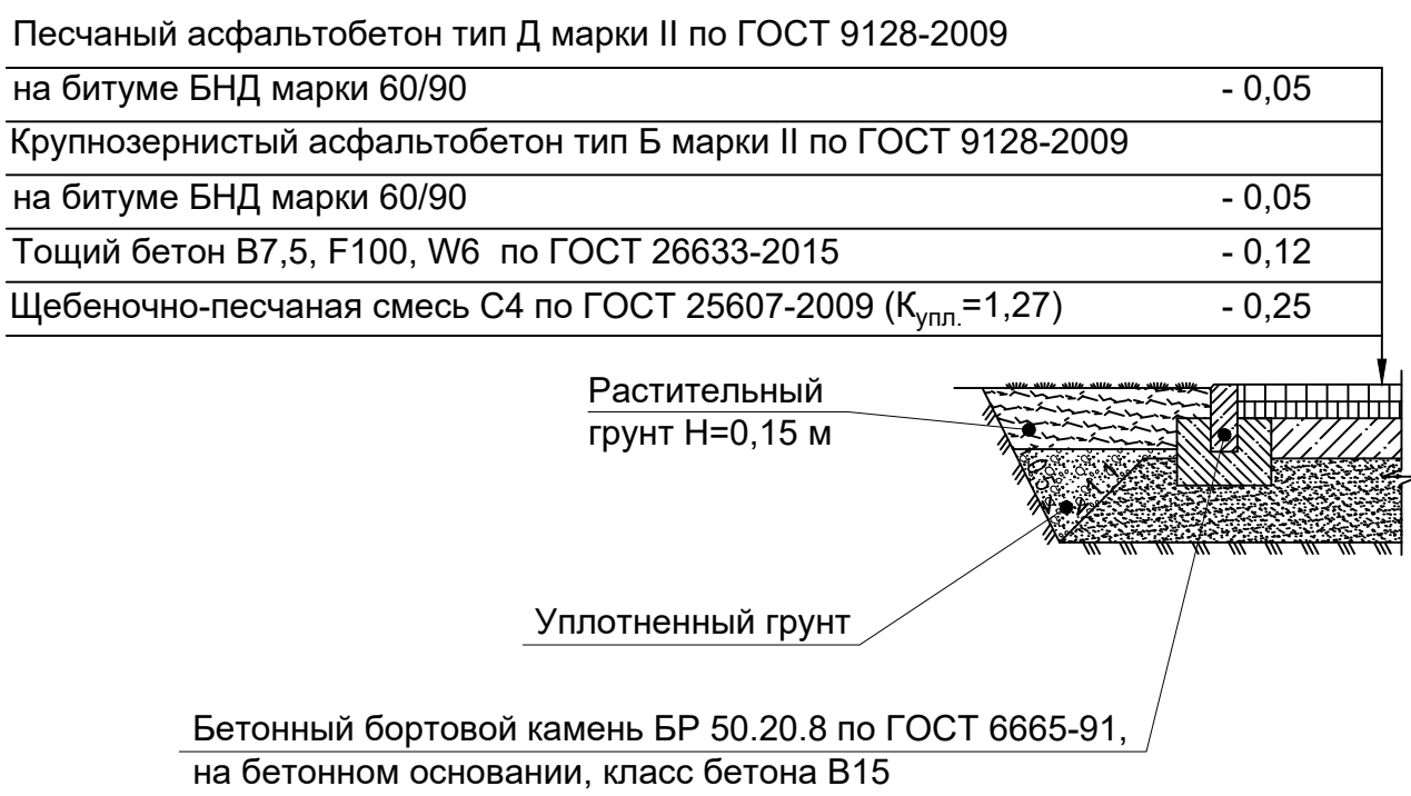
Конструкция тротуара (тип 5)
