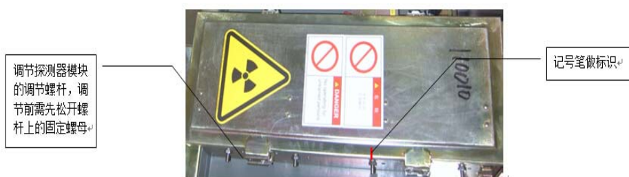
Рис. 7-4 Схема расположения крепежных винтов коллиматора
