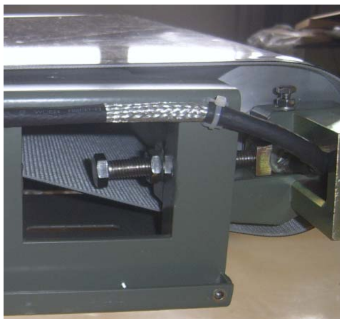
Рис. 7-3 Схема Состояния Натяжения Конвейерной Ленты
